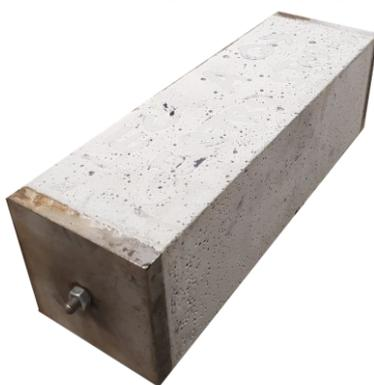
Figura 2: Provini per le prove di espansione contrastata
