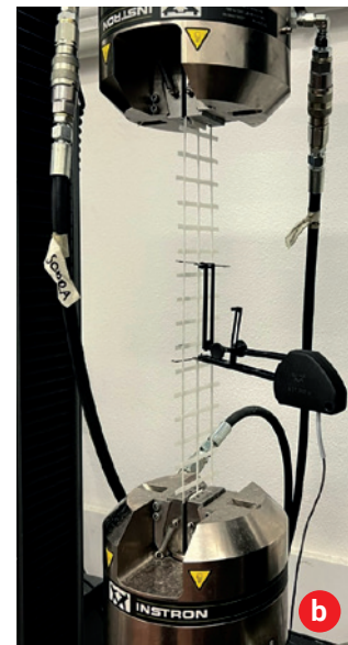
Set-up di prova: a) filo piatto - direzione trama (X); b) filo ritorto - direzione ordito (Y).
