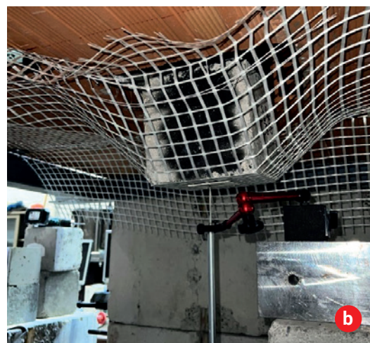
Applicazione del sistema di rinforzo tramite dispositivi di connessione: a) fase precedente all'applicazione del carico; b) fase di prova.
