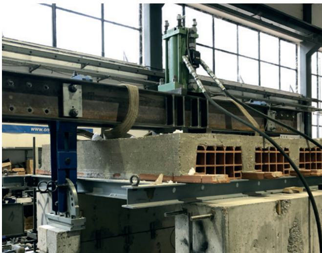
Prove di carico del sistema SAFENET.
