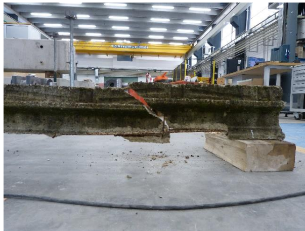
Figura 25 Condizioni del travetto dopo la prova di flessione
