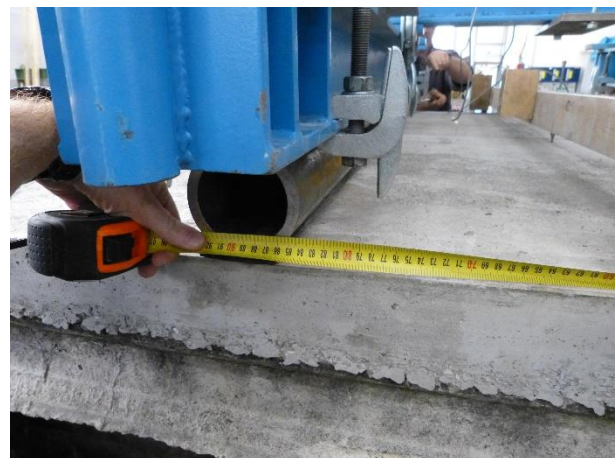
Figura 61 Rilievo di dettaglio della distanza tra i punti di applicazione del carico
