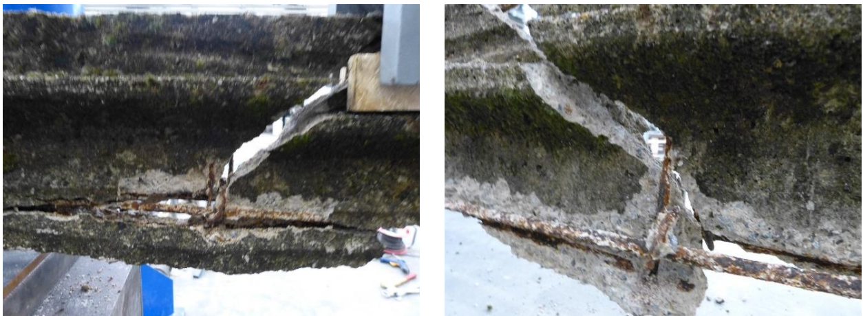
Figura 24 Dettaglio della rottura a fine prova su entrambi i lati del travetto
