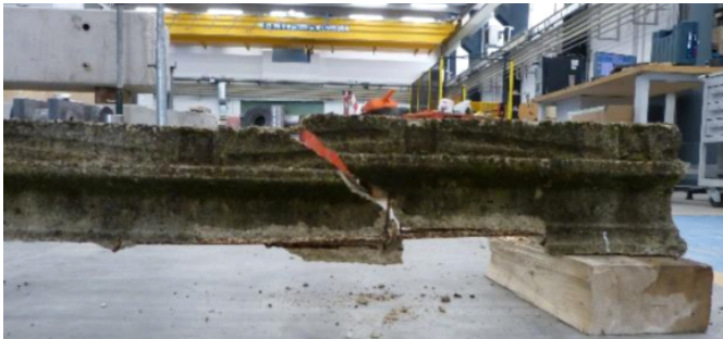
Rottura a taglio singolo travetto
