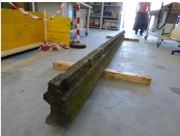
Figura 40 Condizioni del travetto prima della prova di flessione, con dettaglio della fessurazione longitudinale
