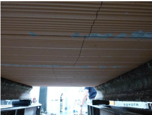
Figura 100 Condizioni delle tavelle dopo aver rimosso lo strato inferiore (probabilmente non dovuto alla prova ma al ritiro della cappa di rinforzo)
