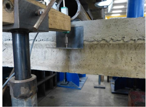
Figura 131 Formazione della cerniera plastica in mezzaria del travetto con la presenza di fessure perpendicolari al travetto
