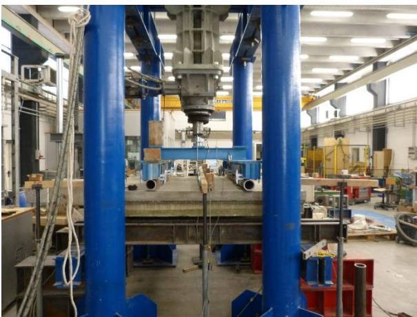
Figura 47 Setup di prova utilizzato per le prove di flessione in 4 punti
