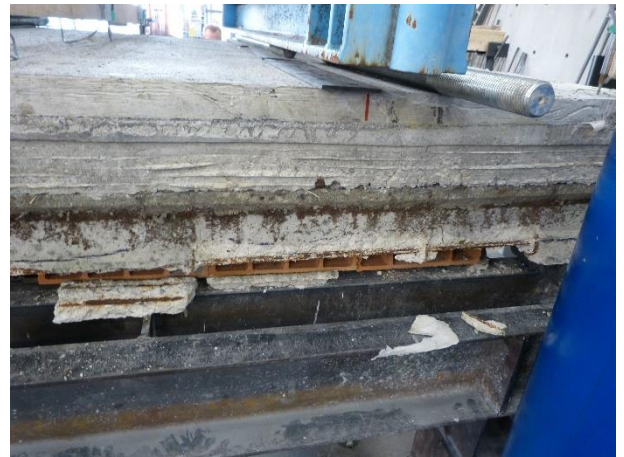
Figura 83 Condizione del travetto 3 nella porzione tra i coltelli di carico
