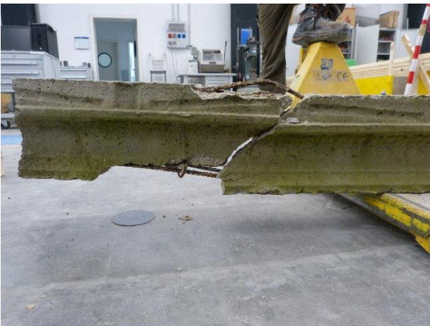
Figura 30 Dettaglio della fessurazione diagonale del travetto con evidente deformazione plastica della barra superiore ed espulsione di copriferro all'intradosso
