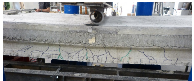
Rottura a flessione su solaio rinforzato
