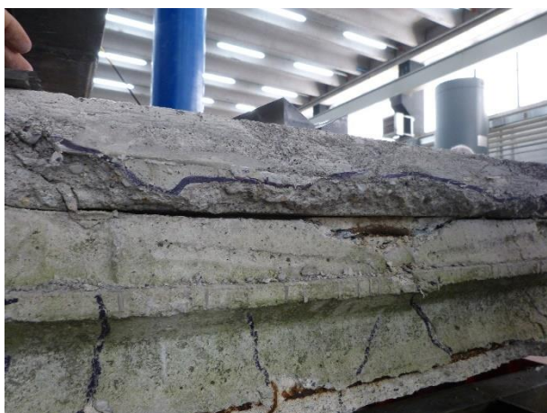
Figura 180 Particolare del distacco tra la cappa di rinforzo ed il substrato
