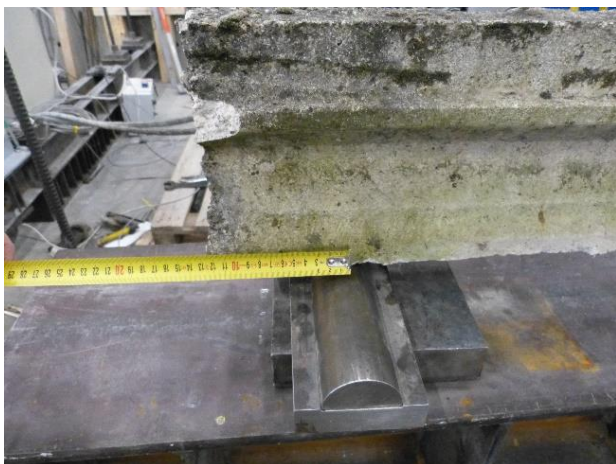
Figura 17 Vista di dettaglio dei punti d'appoggio cerniera (a sinistra) e carrello (a destra)
