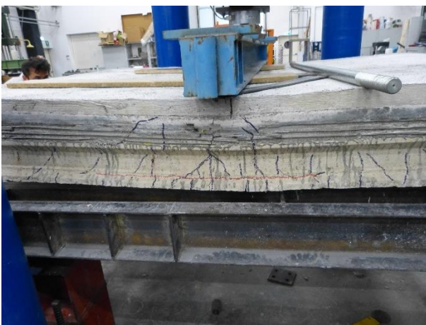
Figura 148 Condizioni del travetto 3 a fine prova
