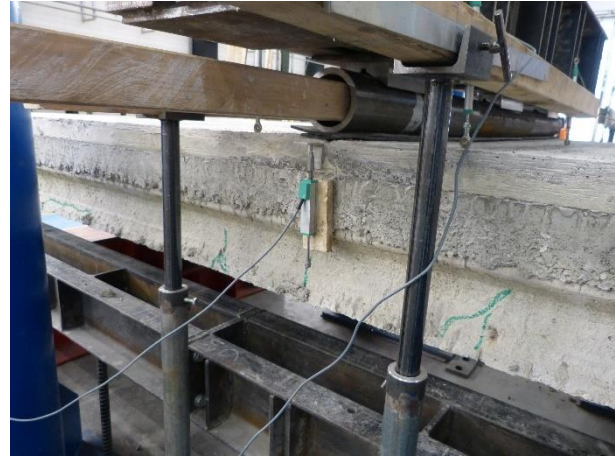
Figura 172 Condizioni generali del travetto 3 (in verde il rilievo delle fessure)
