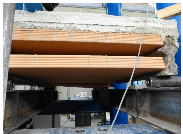
Figura 85 Vista interna tra i travetti 2 e 3 con il collasso del calcestruzzo all'intradosso del travetto 3 con perdita dell'appoggio delle tavole
