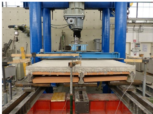
Figura 47 Setup di prova utilizzato per le prove di flessione in 4 punti
