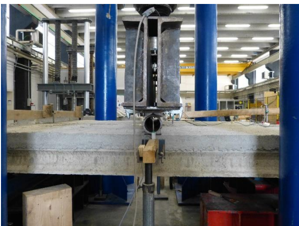
Figura 48 Dettaglio del punto di applicazione del carico
