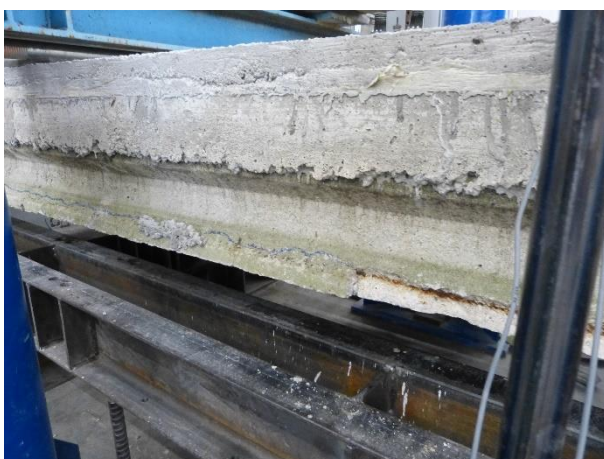
Figura 108 Condizioni dell'appoggio sinistro del travetto 3 (in blu il rilievo delle fessure)
