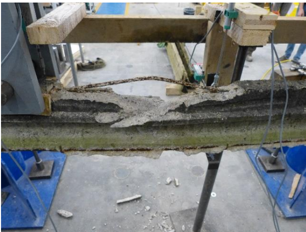
Figura 38 Condizioni del travetto dopo la prova di flessione
