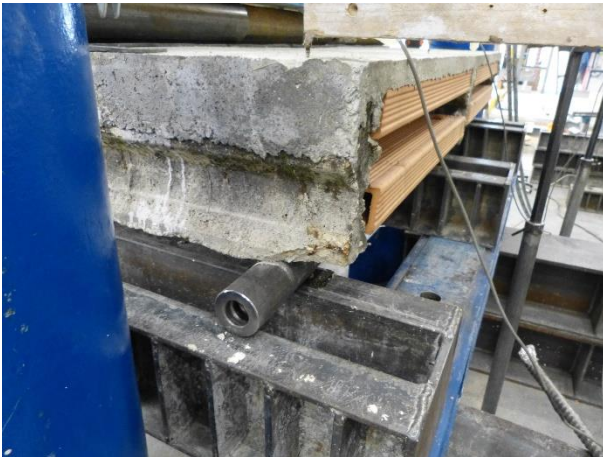
Figura 59 Dettaglio degli appoggi in cui si può osservare la condizione del travetto prima della prova
