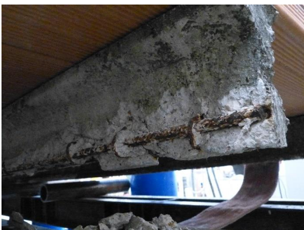
Figura 119 Condizione dell'appoggio destro del travetto 2 a fine prova
