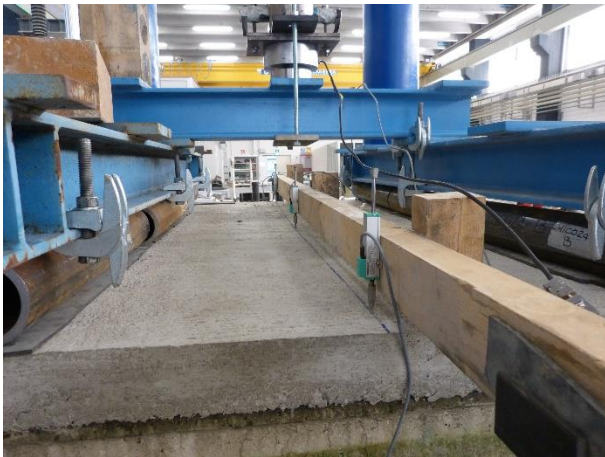
Figura 51 Strumentazione utilizzata per la lettura della freccia massima in mezzeria nelle prove in 4 punti
