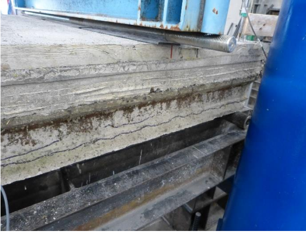
Figura 72 Dettaglio del travetto 3 in cui si può osservare lo stato di degrado prima della prova
