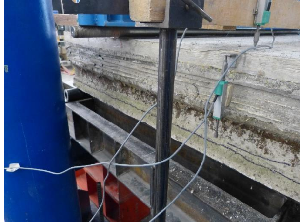
Figura 72 Dettaglio del travetto 3 in cui si può osservare lo stato di degrado prima della prova
