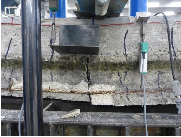
Figura 164 Condizioni del travetto 1 a fine prova
