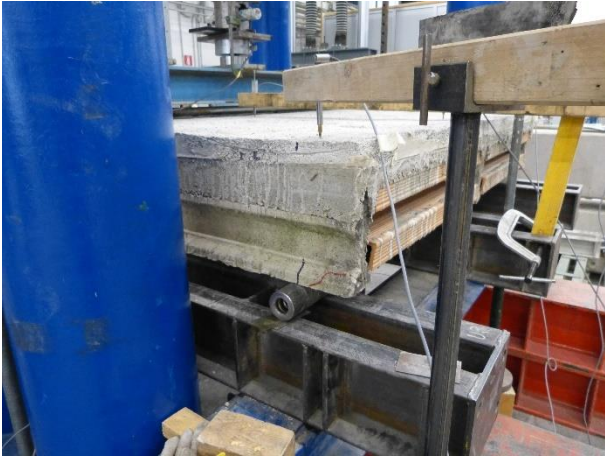
Figura 140 Condizione dell'appoggio destro del travetto 1 ad inizio prova
