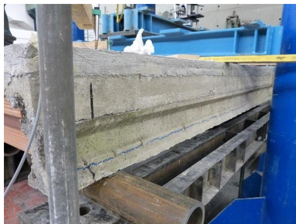
Figura 106 Condizioni dell'appoggio destro del travetto 3 (in blu il rilievo delle fessure)
