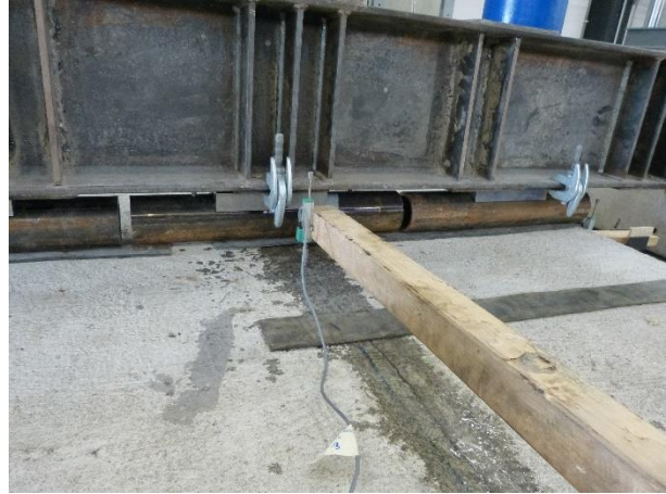
Figura 53 Strumentazione utilizzata per la lettura della freccia massima in mezzeria dei travetto centrale nelle prove in 3 punti
