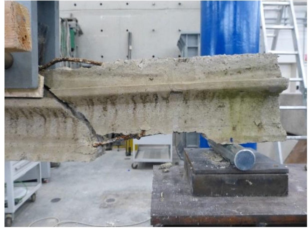
Figura 29 Dettaglio della fessurazione diagonale del travetto nelle due facce
