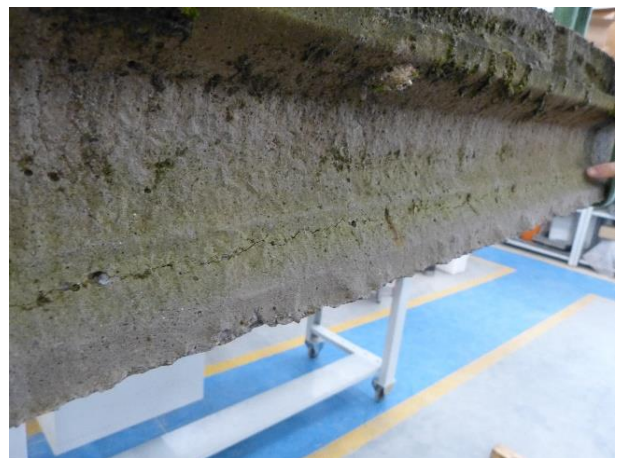
Figura 40 Condizioni del travetto prima della prova di flessione, con dettaglio della fessurazione longitudinale
