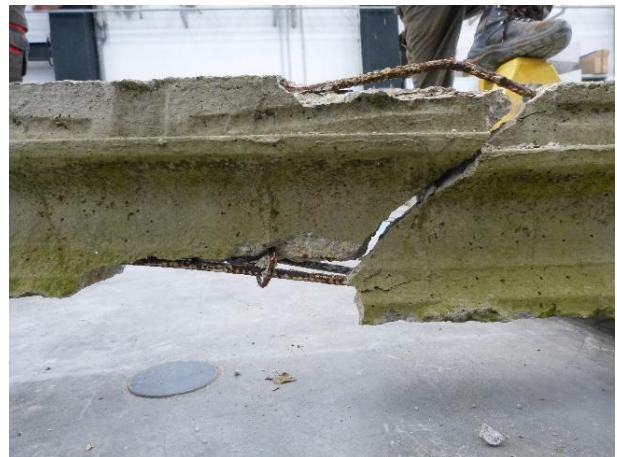
Figura 30 Dettaglio della fessurazione diagonale del travetto con evidente deformazione plastica della barra superiore ed espulsione di copriferro all'intradosso
