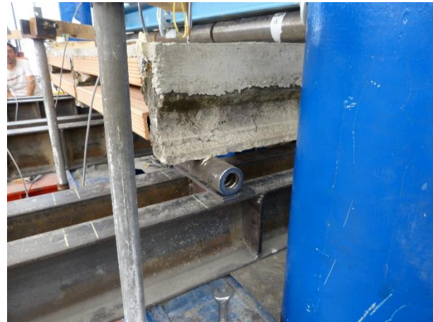
Figura 59 Dettaglio degli appoggi in cui si può osservare la condizione del travetto prima della prova
