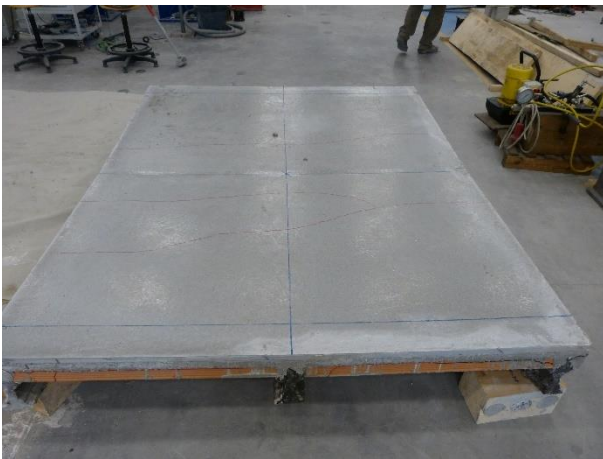
Figura 166 Quadro fessurativo della cappa a fine prova (non si notano fessurazioni aggiuntive)
