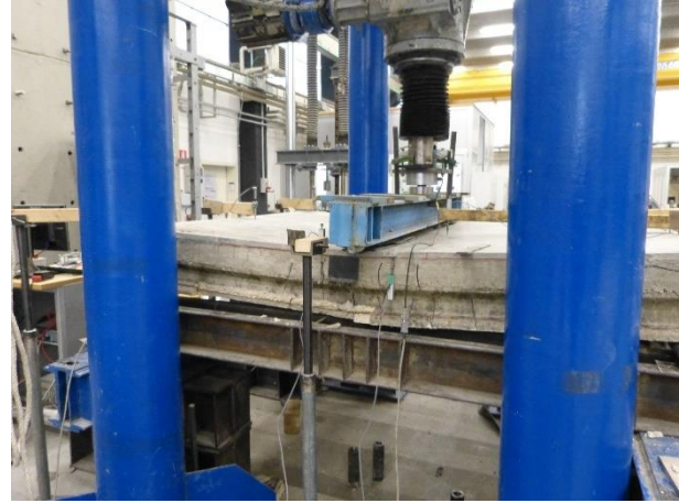
Figura 164 Condizioni del travetto 1 a fine prova
