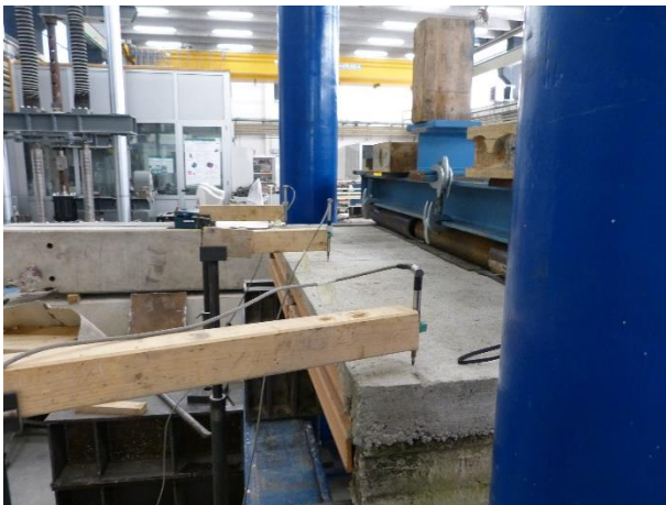
Figura 50 Strumentazione utilizzata per la lettura dei cedimenti agli appoggi
