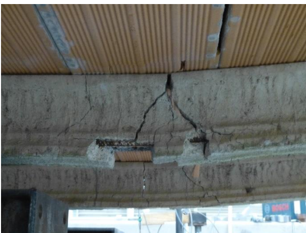
Figura 149 Condizioni del travetto centrale a fine prova
