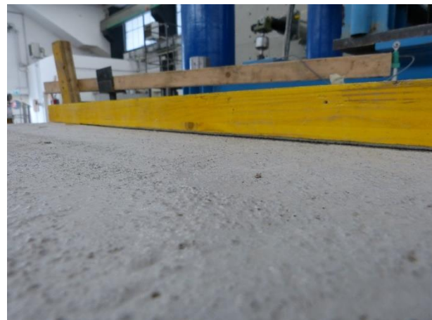
Figura 104 Rilievo della perdita della planarità dell'estradosso della cappa
