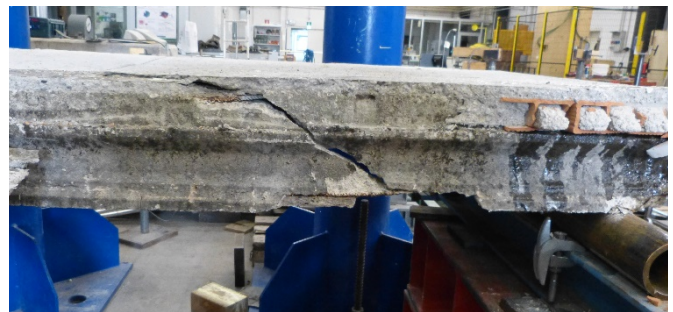
Rottura a taglio su solaio non rinforzato
