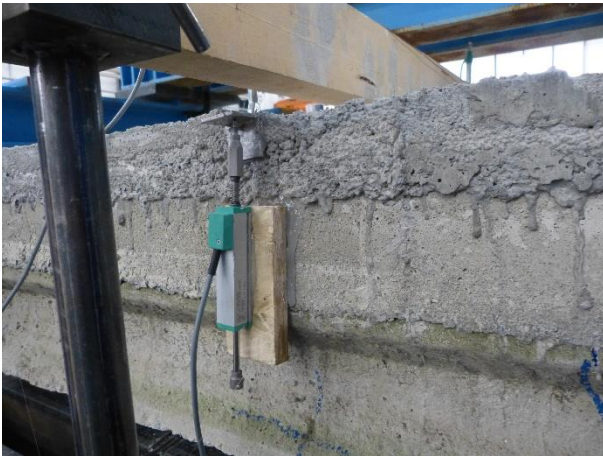
Figura 54 Strumentazione utilizzata per la lettura del distacco tra cappa esistente e rinforzo
