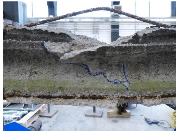
Figura 37 Dettaglio dell'espulsione del copriferro all'estradosso con instabilità della barra
