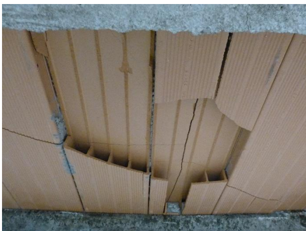
Figura 134 Condizione delle pignatte superiori a fine prova
