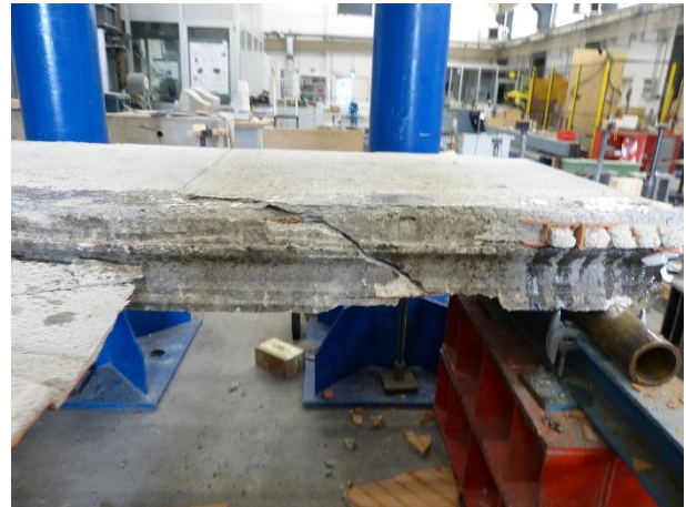
Figura 133 Fessura a taglio nel travetto 2 (centrale) che ha portato alla perdita di capacità portante del solaio
