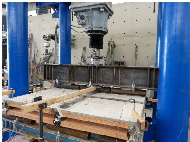
Figura 124 Vista superiore del solaio
