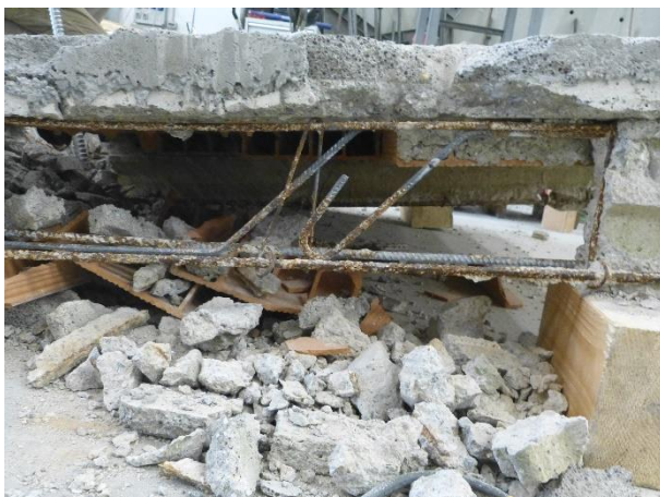
Figura 13 Dettaglio dell'armatura inclinata nei travetti lunghi
