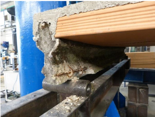
Figura 70 Condizione dell'appoggio di destra del travetto 1 a fine prova
