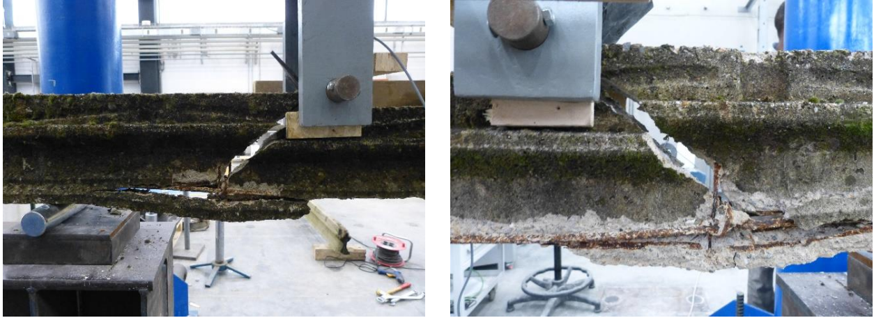
Figura 23 Dettaglio della rottura a taglio in prossimità del vincolo di carrello
