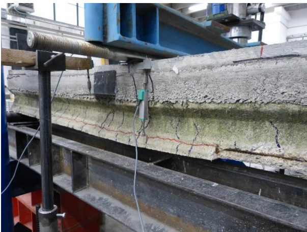
Figura 165 Condizioni del travetto 3 a fine prova
