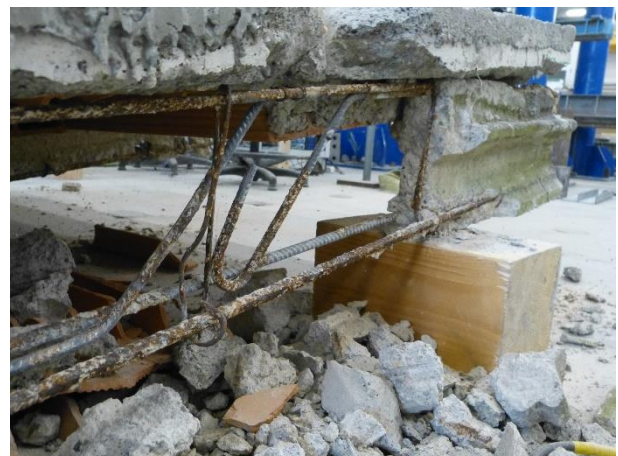
Figura 13 Dettaglio dell'armatura inclinata nei travetti lunghi
