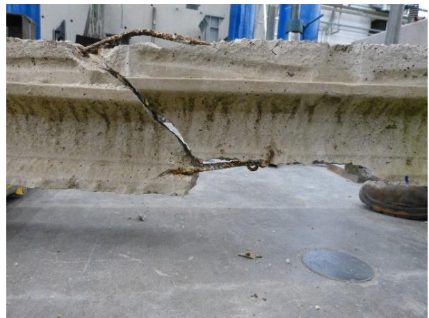
Figura 31 Condizioni del travetto dopo la prova di flessione in 4 punti
