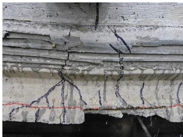
Figura 148 Condizioni del travetto 3 a fine prova
