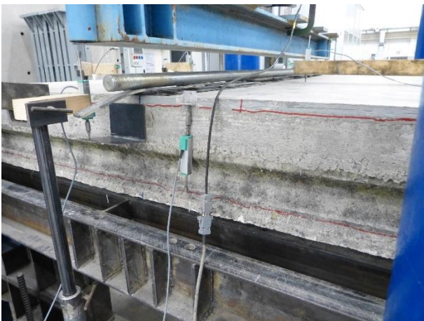
Figura 157 Condizioni dei travetti a inizio prova (fessure evidenziate in rosso)
