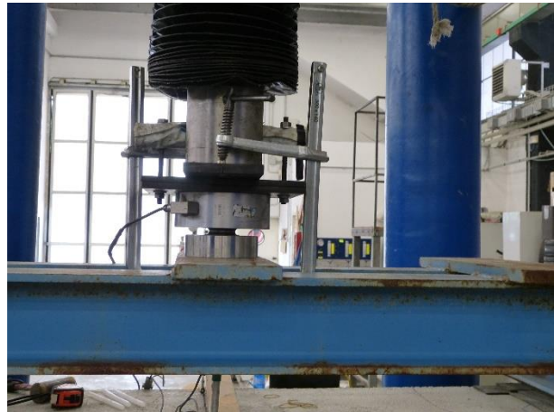
Figura 55 Strumentazione utilizzata per il rilevamento del carico
