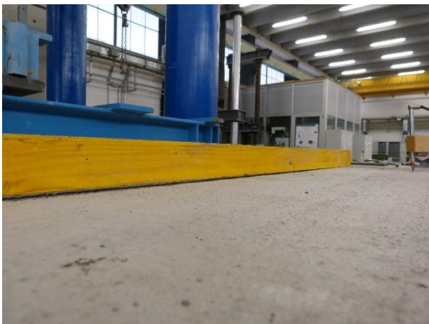
Figura 104 Rilievo della perdita della planarità dell'estradosso della cappa
