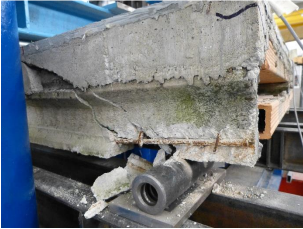
Figura 99 Condizioni dell'appoggio destro del travetto 1 a fine prova
