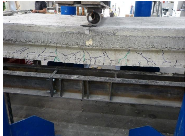
Figura 182 Dettaglio della formazione della cerniera plastica nel travetto 3
