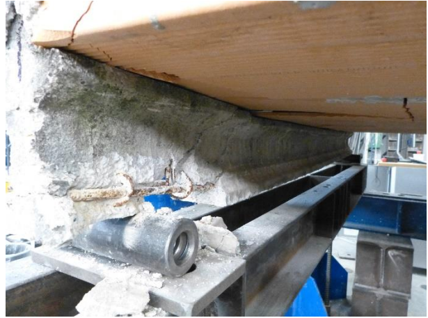
Figura 99 Condizioni dell'appoggio destro del travetto 1 a fine prova
