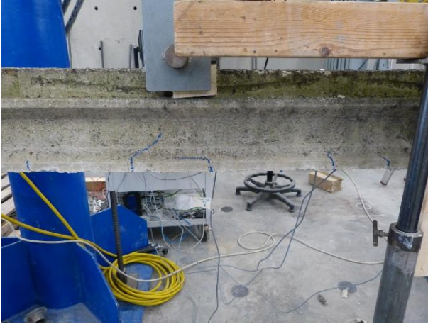
Figura 36 Dettaglio del quadro fessurativo a fine prova
