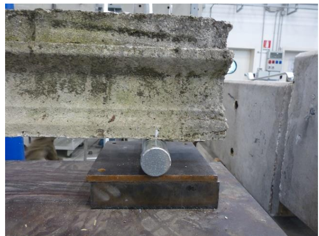
Figura 17 Vista di dettaglio dei punti d'appoggio cerniera (a sinistra) e carrello (a destra)
