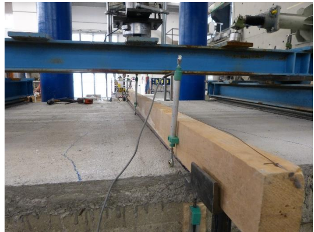
Figura 51 Strumentazione utilizzata per la lettura della freccia massima in mezzeria nelle prove in 4 punti
