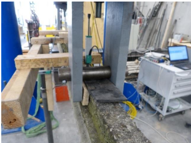
Figura 16 Vista di dettaglio dei punti di applicazione del carico
