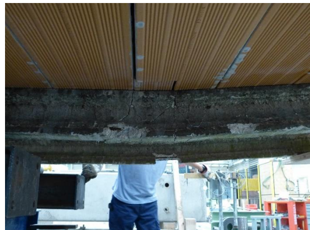
Figura 165 Condizioni del travetto 3 a fine prova
