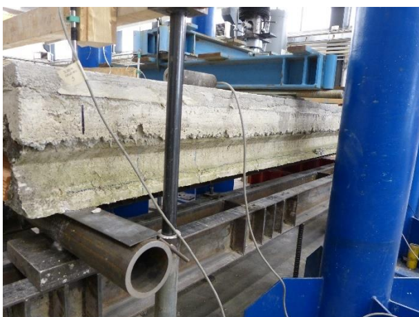
Figura 107 Condizioni dell'appoggio sinistro del travetto 1 (in blu il rilievo delle fessure)
