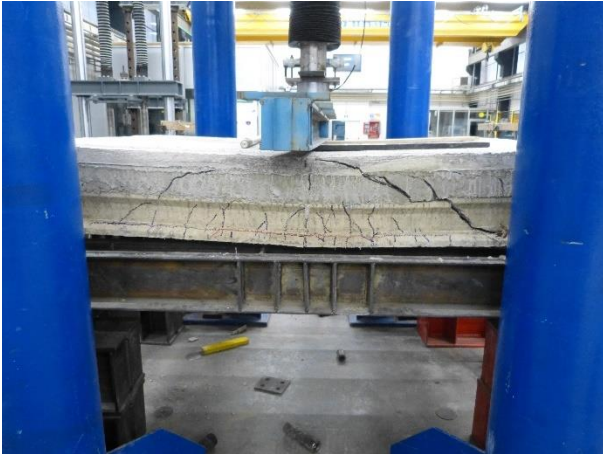
Figura 147 Condizioni del travetto 1 a fine prova con dettaglio della rottura a taglio del travetto
