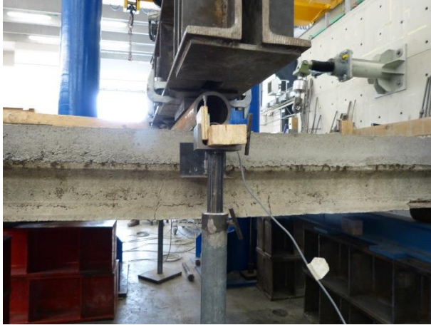
Figura 131 Formazione della cerniera plastica in mezzaria del travetto con la presenza di fessure perpendicolari al travetto
