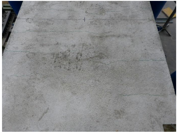
Figura 168 Quadro fessurativo della cappa collaborante prima di iniziare la prova
