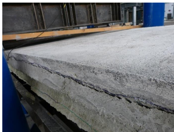
Figura 180 Particolare del distacco tra la cappa di rinforzo ed il substrato
