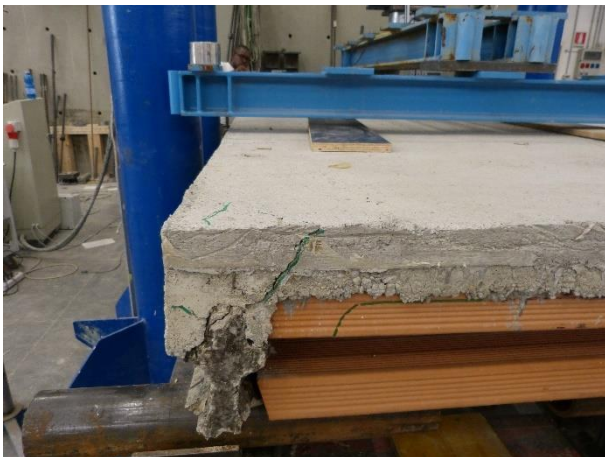
Figura 117 Condizioni dell'appoggio destro del travetto 1 a fine prova
