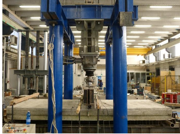
Figura 46 Setup di prova utilizzato per le prove di flessione in 3 punti
