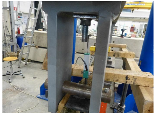
Figura 16 Vista di dettaglio dei punti di applicazione del carico
