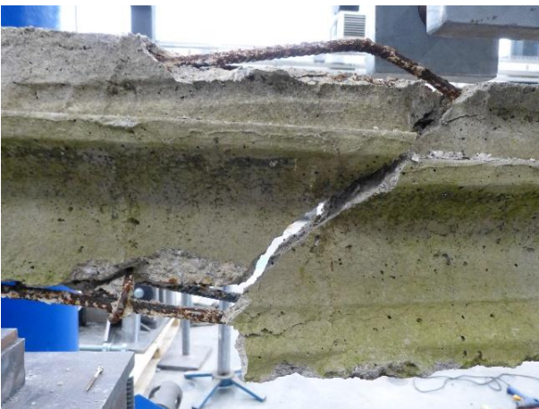
Figura 31 Condizioni del travetto dopo la prova di flessione in 4 punti
