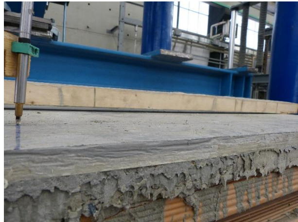
Figura 87 Dettaglio della perdita di planarità (luce tra il riferimento ligneo e il solaio) della superficie
