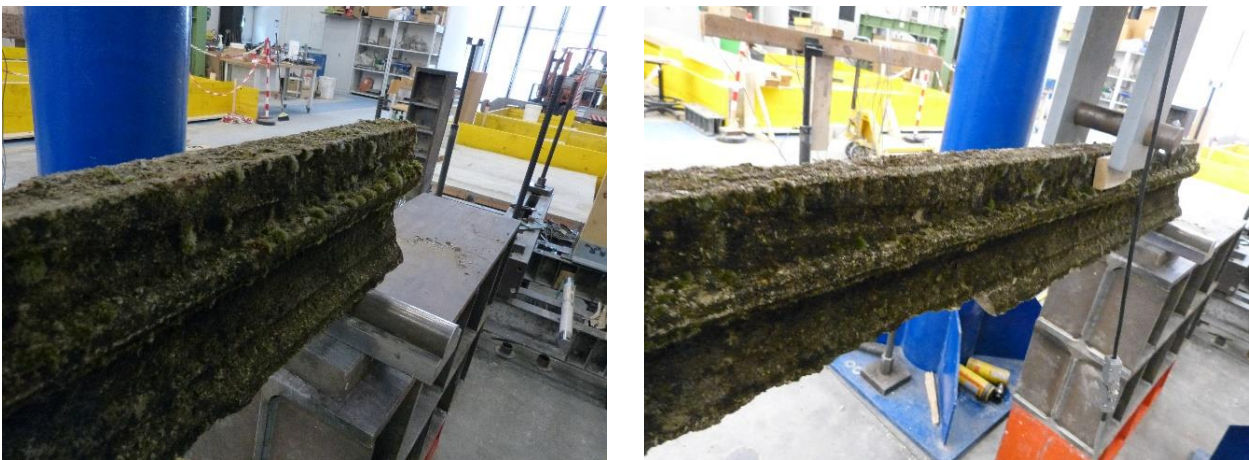
Figura 20 Condizioni del travetto prima dell'esecuzione della prova
