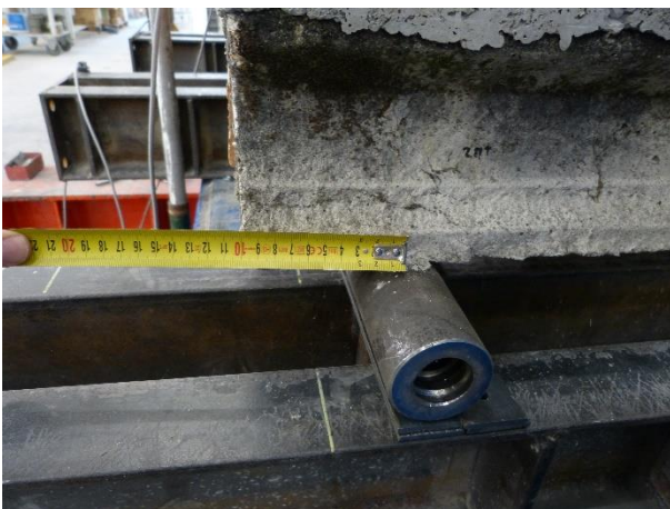
Figura 60 Dettaglio della misura tra il centro dell'appoggio ed il bordo
