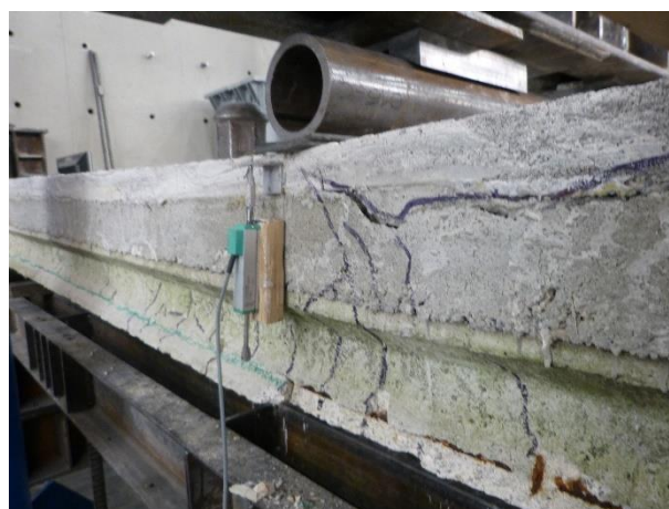
Figura 179 Dettaglio della formazione della cerniera plastica nel travetto
