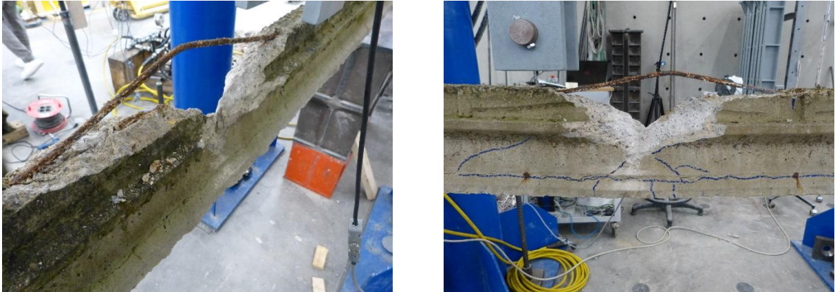
Figura 43 Condizioni dei travetti a fine test con dettaglio dell'instabilità del corrente superiore
