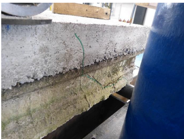
Figura 66 Dettaglio della rottura per taglio del travetto 1 in prossimità dell'appoggio destro
