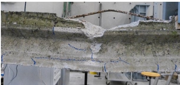
Rottura a flessione singolo travetto
