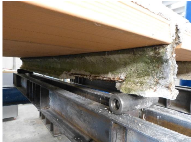
Figura 71 Condizione dell'appoggio di destra del travetto 2 a fine prova
