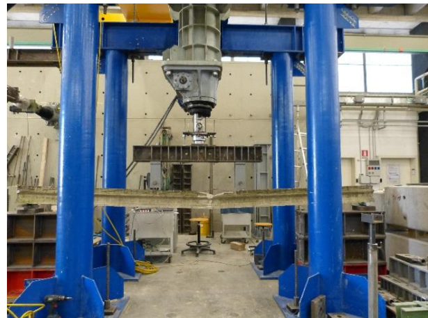
Figura 38 Condizioni del travetto dopo la prova di flessione
