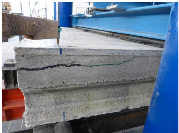
Figura 102 Condizioni dell'appoggio destro del travetto 3 a fine prova
