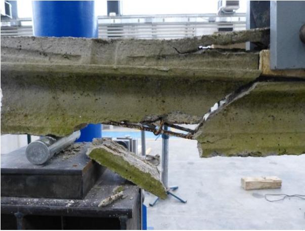
Figura 29 Dettaglio della fessurazione diagonale del travetto nelle due facce
