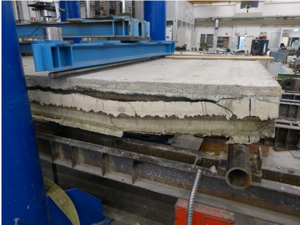
Figura 115 Dettaglio del collasso per taglio dell'appoggio destro del travetto 1
