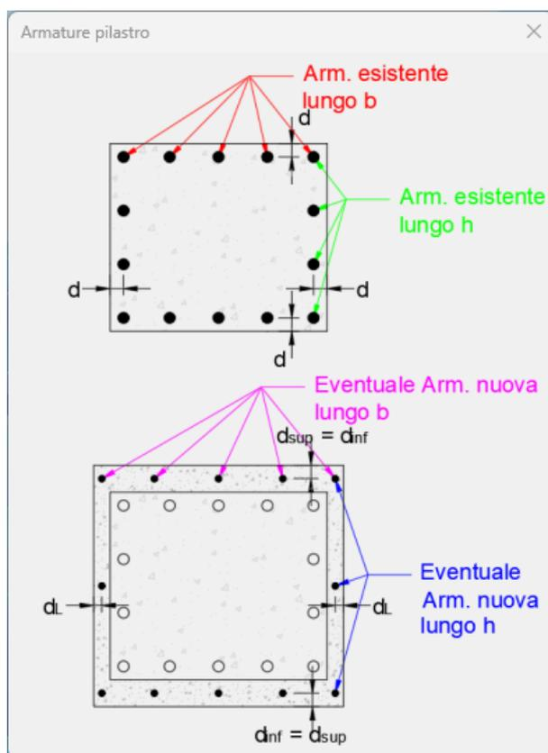
Si specifica che le armature devono essere inserite considerando il totale delle armature presenti lungo i lati orizzontale  $b$  e verticale  $h$  rispettivamente, incluse le armature presenti negli angoli. Il software riconosce in automatico che due barre lungo  $b$  e due barre lungo  $h$  inserite rappresentano gli elementi d'angolo.
