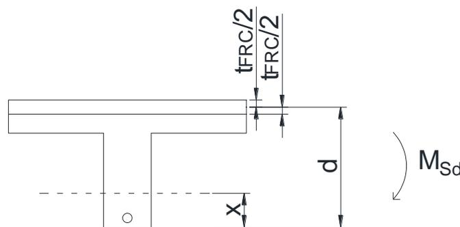
L'altezza utile dell'armatura equivalente è misurata dall'estremo lembo compresso (intradosso) sino al baricentro della nuova soletta in calcestruzzo fibrorinforzato. Qualora nella nuova soletta sia presente armatura integrativa, il software valuta l'altezza utile maggiore tra quella relativa all'armatura integrativa e quella relativa all'armatura equivalente del calcestruzzo fibrorinforzato.
