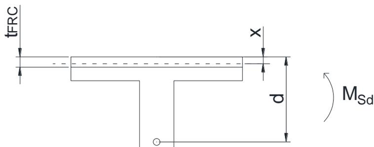
Nelle zone soggette a momento positivo con asse neutro ricadente nel solaio esistente, il calcestruzzo fibrorinforzato risulta interamente compresso; pertanto, non vi è un contributo di armatura equivalente.
