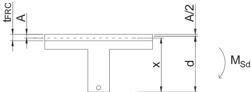
L'altezza utile dell'armatura equivalente è misurata dall'estremo lembo compresso (intradosso) sino al baricentro della porzione tesa della nuova soletta in calcestruzzo fibrorinforzato. Qualora nella nuova soletta sia presente armatura integrativa, il software valuta l'altezza utile maggiore tra quella relativa all'armatura integrativa e quella relativa all'armatura equivalente del calcestruzzo fibrorinforzato.
