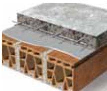
Solai in CLS Connettore Chimico
